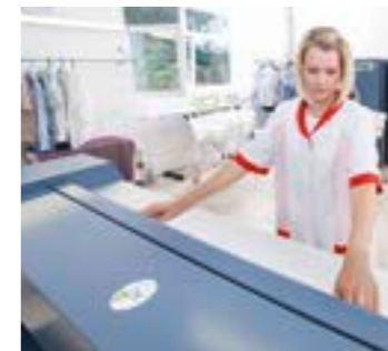
Für das Bügeln und Pressen reicht eine Lichtstärke von 300 Lux.
