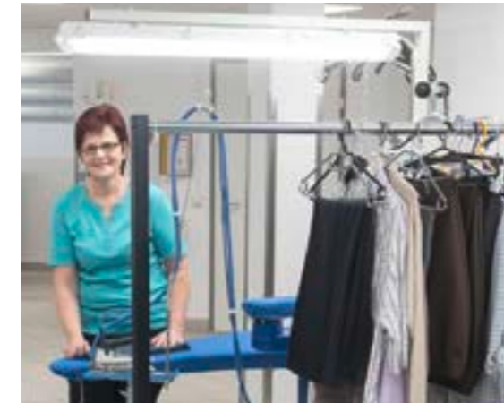
Für das Bügeln und Pressen reicht eine Lichtstärke von 300 Lux.
