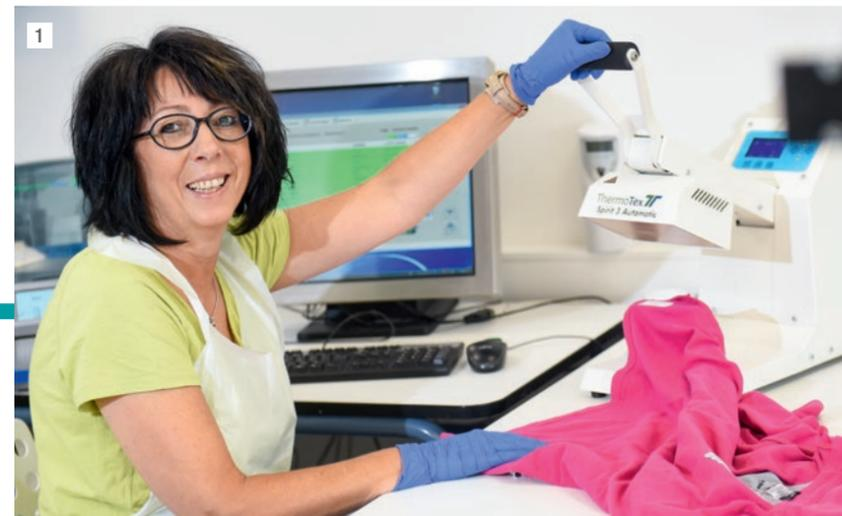
So spart man Zeit: Andrea Wallasch (1) patcht neue Textilien mit dem Chip. Mit der digitalen RFID-Technik von Thermotex kann der Weg eines Textils nachvollzogen werden. Zum Beispiel, wenn ein Shirt gefinisht ist (2). Angelika Wetzel (3) benutzt die Bügelpuppe von Veit, um ein Hemd zu finishen – das geht schneller als mit dem Handbügelleisen.
